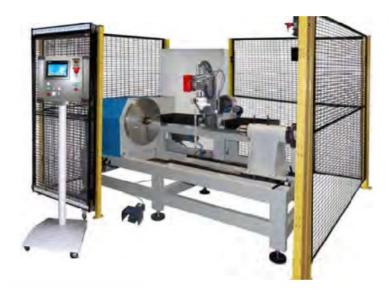
Машина для намотки больших роторов BM-1000 (ROTOR)
