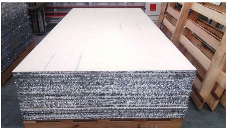
На фото: готовые сэндвич-панели с сотовым наполнителем
