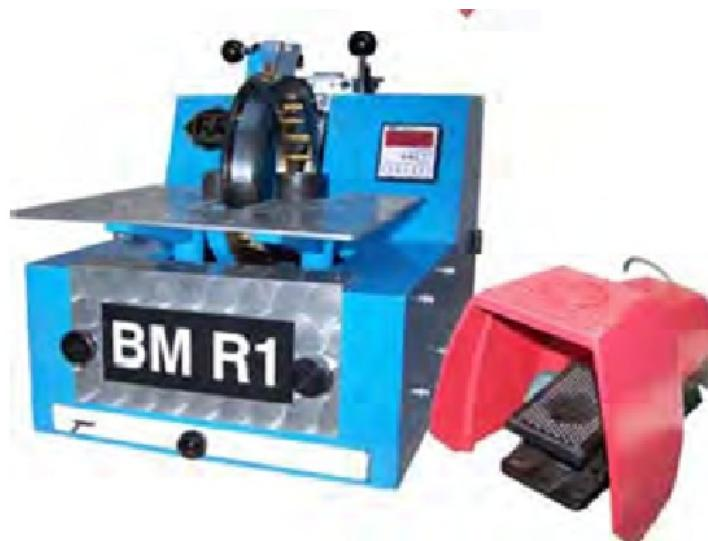
Машина для лентообмотки торайдов BM-R1
