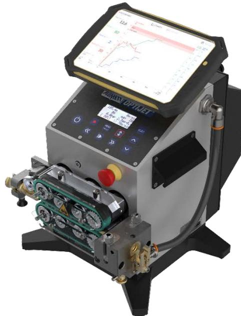
Интеллектуальная задувочная машина Optijet - предназначена для задувки телекоммуникационных микрокабелей (оптических, коаксиальных и медных многопарных) диаметром от 1,5 до 8 мм в предварительно проложенные микротрубки наружным диаметром от 3 до 16 мм, а также для обеспечения наибольшей эффективности процесса и записи параметров задувки с последующим формированием отчета.
