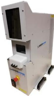
**Mercury-4E** - это расширенная версия нашей очень популярной лазерной зачистки проводов Mercury-4. Он остается относительно компактным настольным устройством, но обеспечивает площадь обработки 100 мм x 100 мм, что позволяет обрабатывать большее количество кабелей одновременно.
